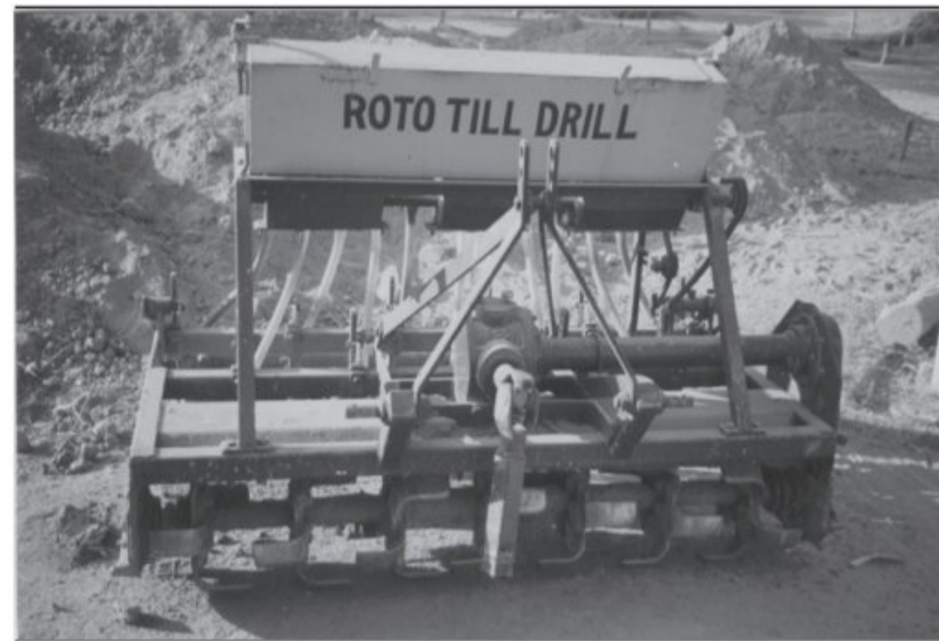
चित्र 5.12 : रोतो टिल ड्रिल - एक अत्याधुनिक कृषि उपकरण
